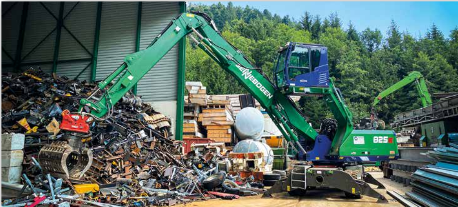
Elektrisch angetrieben, umweltschonend und effektiv im Schrottschlag: Umschlagbagger SENNEBOGEN 830 E-Serie in der Raupenvariante belädt die Schere mit 17 m-Ausrüstung in einer
