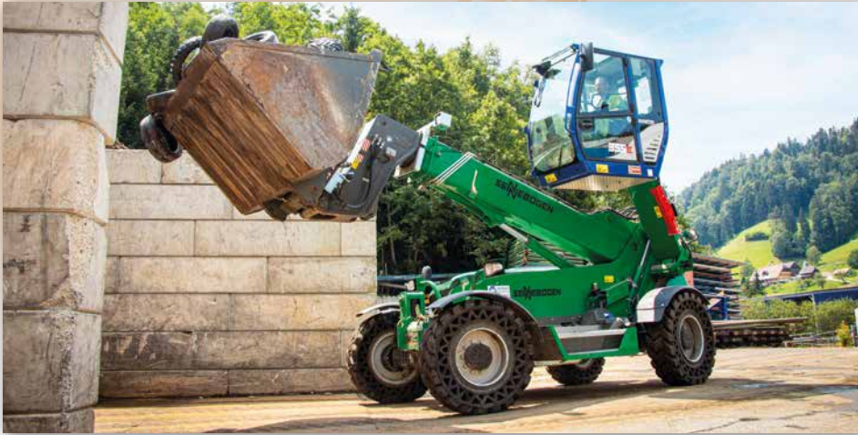
Experte in engen Gassen – Der Teleskoplader SENNEBOGEN 355 E bei der Verladung von Altreifen innerhalb der Sortierboxen
