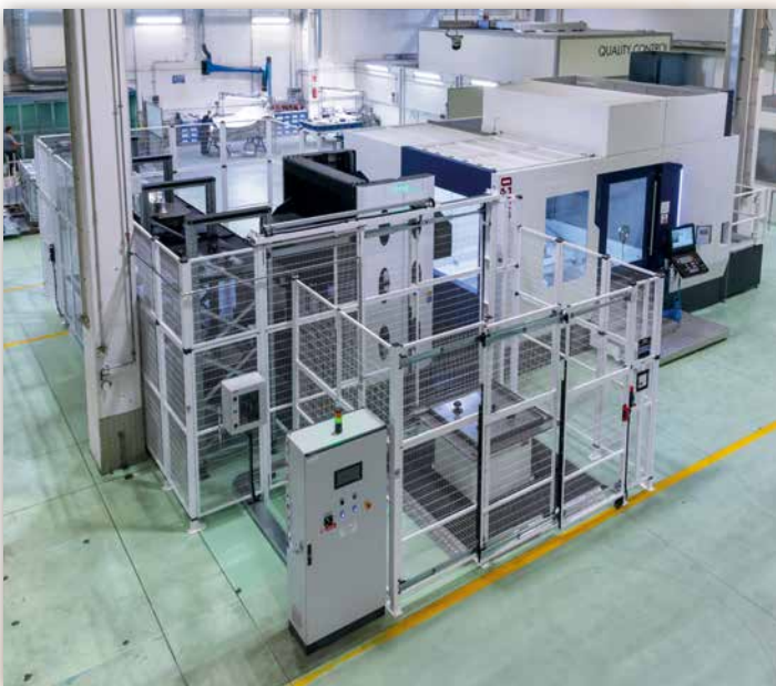
Universal-Bearbeitungszentrum UMILL 1500 mit automatischem Palettenwechselsystem mit 6 Stationen
