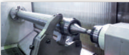
Folienwalzen mit einem Durchmesser von 350 x 3800 mm mit Lünette und Reitstock abgestützt
