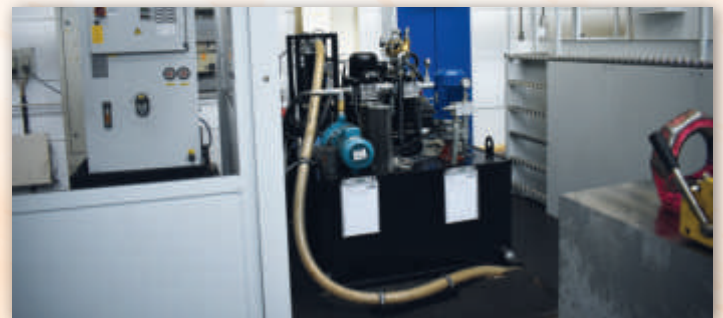
Kombinierte Kühlmittelanlage, die sowohl für die ECOMILL wie auch die Umill 1800 genutzt wird
