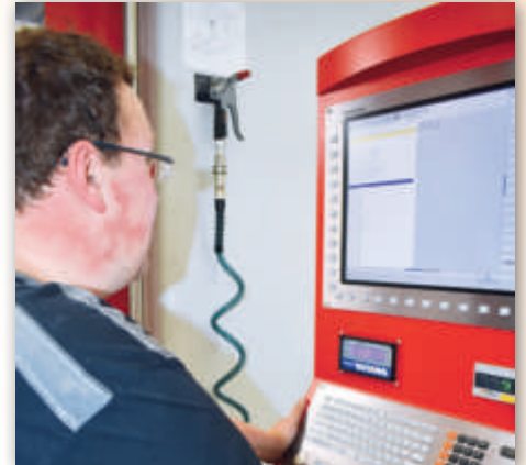
Ergonomische Gestaltung des Bedienpults mit großem 19" Bildschirm
