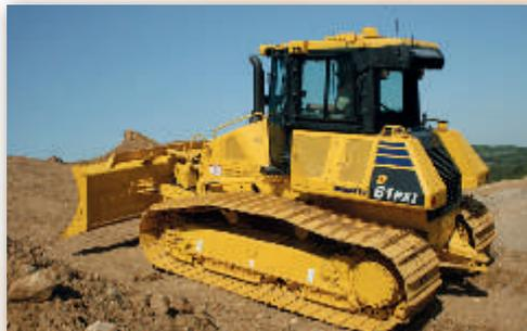
D61PXi-23 mit integriertem GPS-System
